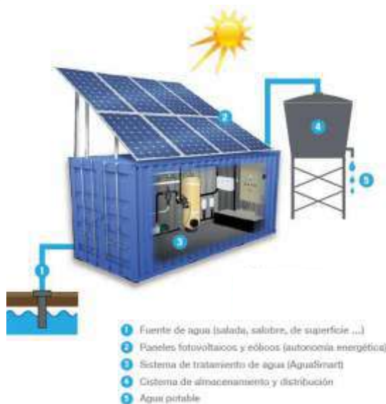
MÓDULO DE TRATAMIENTO DE AGUAS
